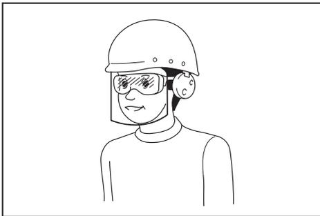
**Menjadi tanggung jawab atasan untuk menerapkan penggunaan alat pelindung keselamatan yang tepat bagi operator mesin dan orang lain yang berada di area kerja saat itu.**
